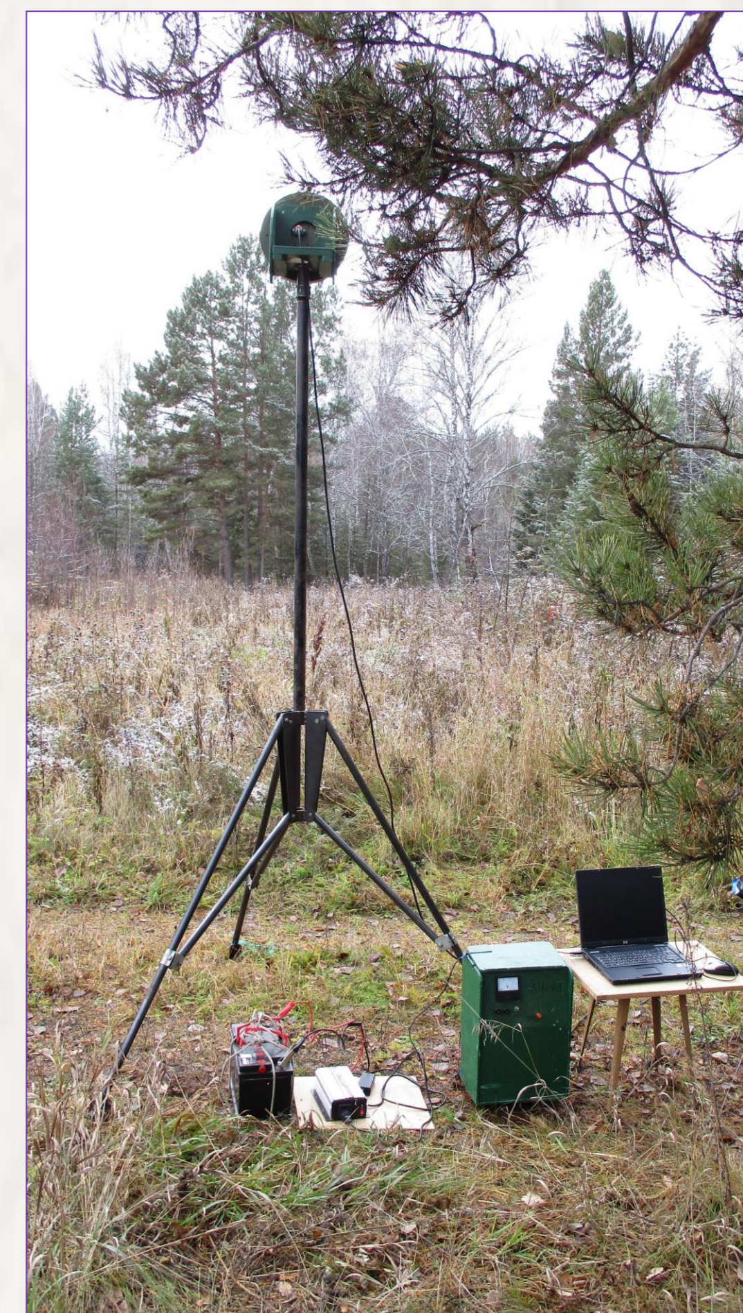
Рис.5. Автономный измерительно-регистрирующий комплекс на базе серийного приемника сигналов ГЛОНАСС/GPS МРК-32Р.
