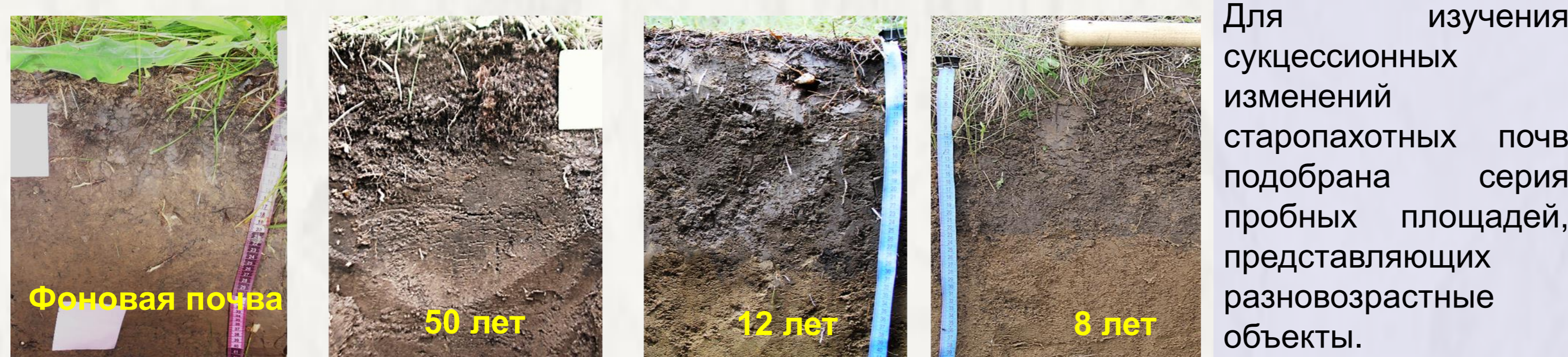
Рис.6. Почвенные профили на участках с различной стадией постагрогенного восстановления. Морфологические признаки анализировались с использованием авторского метода съемки в инфракрасном (ИК) диапазоне ( \lambda = 7 - 13 мкм) с помощью системы FLIR INFRACam. Результаты съемки после процесса калибровки представляют собой двумерный массив температурного поля профиля, с пространственным разрешением не хуже 2x2 см, чувствительностью не хуже 0,1 К.
