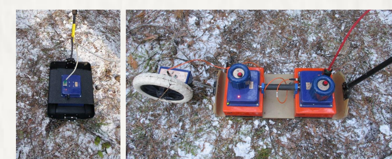
Рис.8. Георадар «ОКО-2» - излучатель и приемник низкочастотных сигналов (антенна), которые преобразуются и выводятся на компьютер в виде радарограммы.
